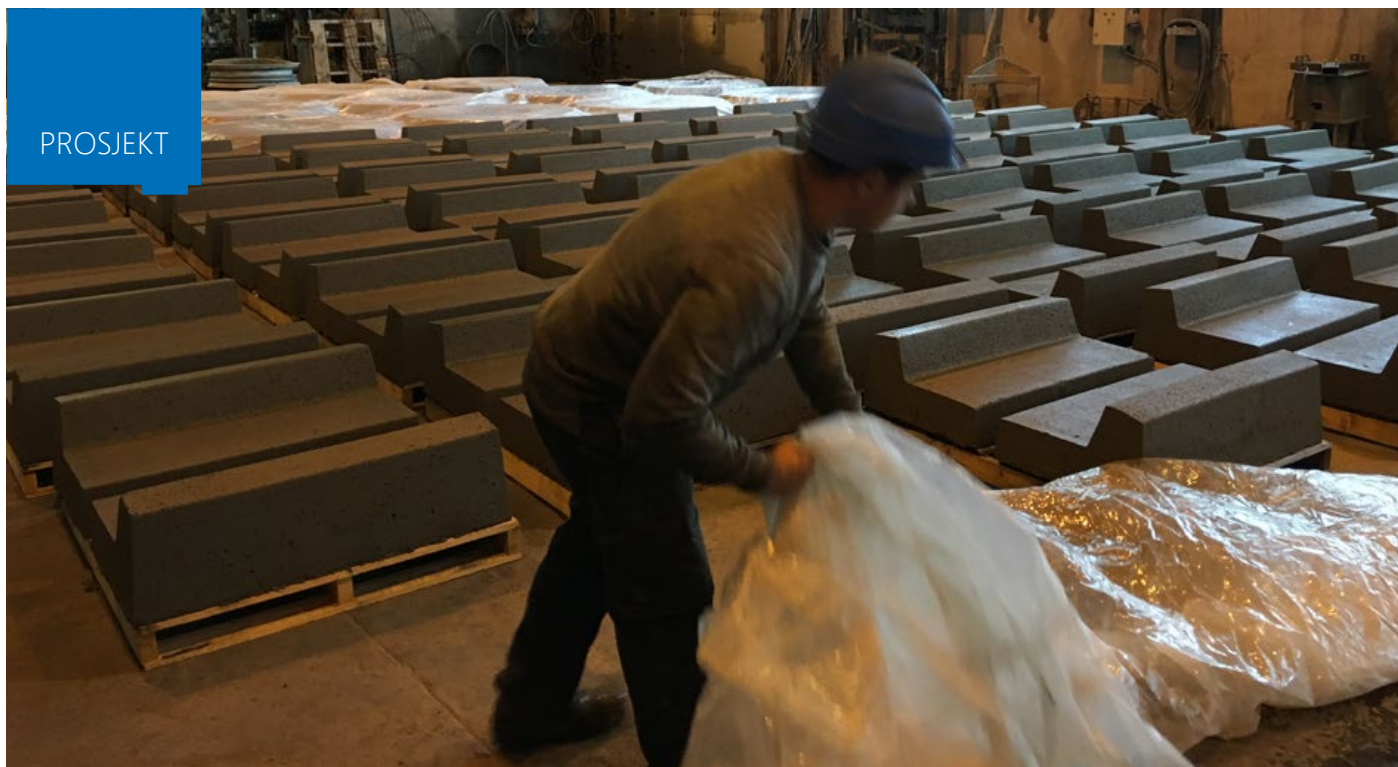
bildet viser ferdig produserte fundamenter til veggelementene
